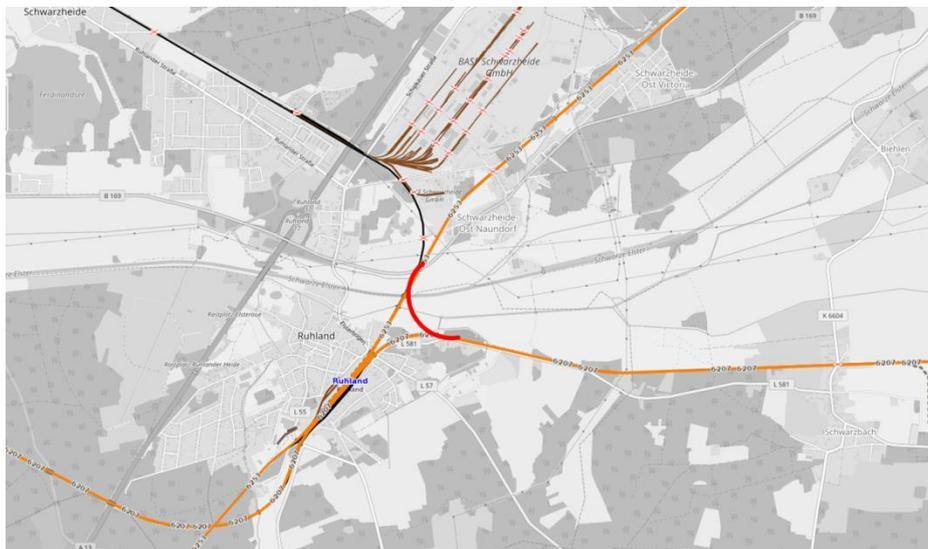
**Abbildung 2: Prinzipskizze einer Ostkurve Schwarzheide - Niederschlesische Magistrale (eigene Darstellung auf Basis openrailmap.org, rot, nicht maßstabsgerecht dargestellt)**
