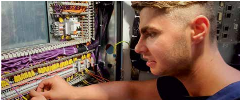
Das Verdrahten ist eine der letzten Stufen in der Fertigung von Schaltanlagen bei SZM. Danach werden die Anlagen im hauseigenen Prüfzentrum überprüft und gehen dann an deutsche Industriekunden oder ins Ausland. Foto: SZM GmbH
