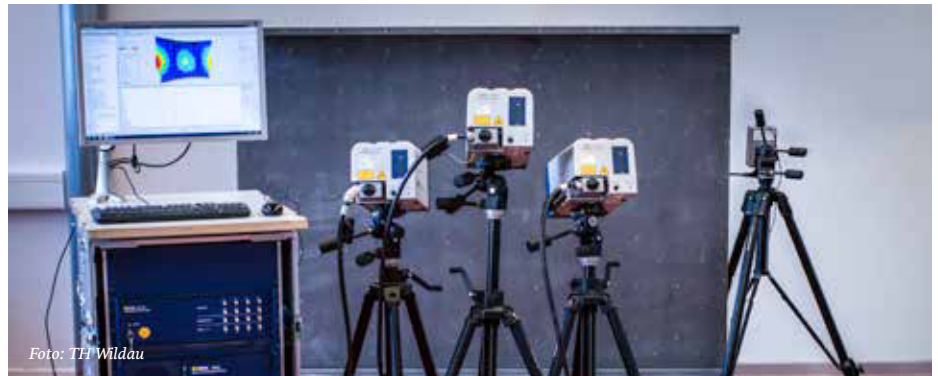
B) Experimenteller Abgleich des digitalen Zwillings mittels 3-D-Laser und doppelter Interferometrie
